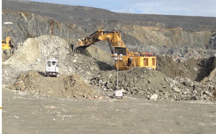
Sécurité des employés : Pelle contrôlée à distance
